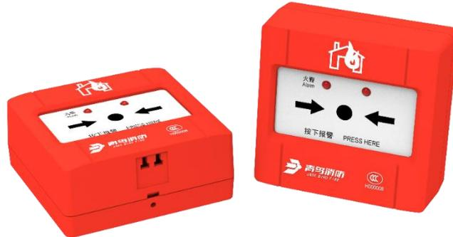
J-SAP-JBF-W1121 手动火灾报警按钮(以下简称手报)是本公司开发的一款二总线手报产品,同时本产品还是基于青鸟 Chrip 无线通讯技术开发的具有无线功能的消防报警系统现场报警设备。CPU 采用自主研发的朱鹮芯片,具有性能稳定,可靠性高的特点。手动按下手报操作面板后,即触发报警信号并上传至传统火灾报警控制器或具有无线功能的控制器、网关、中继器等,从而达到报警的目的。
